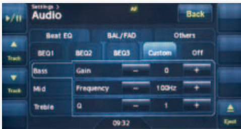
Zur Klangregelung steht unter anderem ein dreibändiger parametrischer Equalizer parat
